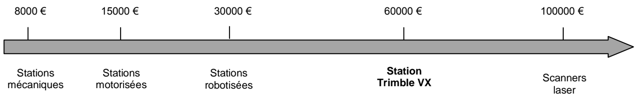
Figure 3 : Positionnement en terme de coût de la station Trimble VX par rapport aux stations totales et aux scanners laser
